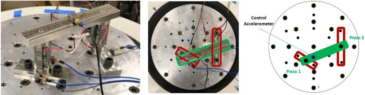
**Figure 1:** Dual piezo setup
